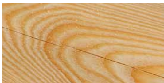
1. Beispielhaft: Gleiches Holz trocken (18%) und nass (hinten).
