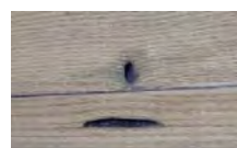
Leere Harzgallen und kleinere Ausfalläste
