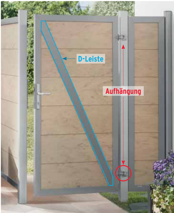
Art. 2443 DESIGN WPC ALU Tor DIN rechts im Farbton Sand. Die Profile der Tore sind in einem umlaufenden Metallrahmen verbaut. Die rückseitige Diagonalverstrebung aus Aluminium im Rahmenfarbton Silber (D-Leiste) bringt zusätzliche Stabilität. Metalltorpfosten mit angeschweisster Aufhängung (Seite 49).
