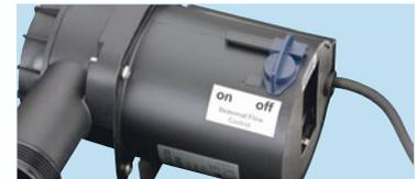
SFC-Schalter: bei Aquamax Eco Premium 12'000/16'000/20'000. Bei eingeschalteter SFC-Funktion optimiert die Pumpe selbstständig Wassermenge und Förderhöhe und reduziert diese bis zu 50%.
