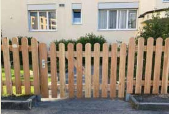
Holzkonstruktion Lärche Leimholz ohne Imprägnierung. Schlossbrett, Schloss mit Schlüssel. Verzinkte Bänder und verstellbare Kloben. Staketentüren Breite und Kopfform nach Wahl, ohne Pfosten und Montage. Lichtbreite 80 - 120 cm.
