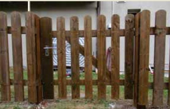
Holzkonstruktion Fichte kesseldruckimprägniert braun. Schlossbrett, Schloss mit Schlüssel. Verzinkte Bänder und verstellbare Kloben. Staketten breite 6 cm oben gerundet ohne Pfosten und Montage. Lichtbreite 80 - 120 cm • Swiss Made
