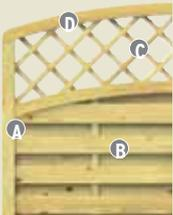
**Material:** Nadelholz (kdi), FSC®**Rahmen (A):** extrastark und stabil, 42 x 68 mm**Lamellen (B):** 9 x 95 mm, glatt gehobelt, mit Rundkanten, kleinstig, überlappend angeordnet**Gitter (C):** Leisten 10 x 30 mm, Maschenweite 100 x 100 mm**Rundbögen (D):** in mehreren Schichten formstabil verleimt**Verschraubung:** Edelstahl
