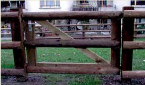
Holzkonstruktion ausgeblattet und verschraubt mit INOX. Schlossbrett, Schloss mit Schlüssel. Verzinkte Bänder und verstellbare Kloben. Verkleidung mit Querlatten, halbrund braun imprägniert ohne Pfosten und Montage. Lichtbreite 80 - 120 cm.
