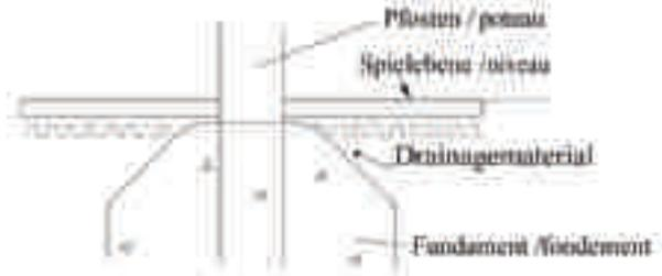
Stützpfosten kann mit hochgezogenem Fundament besser geschützt werden (Fundament muss vollständig mit losem Fallschutzmaterial oder Gummischnitzel überdeckt sein)
