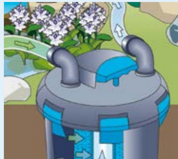
▲ Integrierte UVC-Einheit Das im Deckel integrierte UVC sorgt für die rasche Beseitigung von Algen und Krankheitserregern im Teichwasser.
