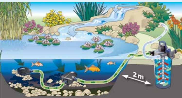
Druckfilter (Seite 17–18) Druckfilter eignen sich für kleinere bis mittelgroße Teiche.
