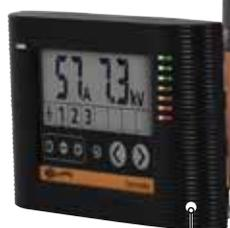
Mühevolle Überwachung und Kontrolle der Zaunleistung - In einer praktischen Position in einem Abstand von bis zu 50 m\* vom Weidezaungerät installieren, um den Zugang zur Zaunsteuerung und das Ablesen der Leistungsdaten zu erleichtern.
