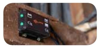
Um sicherzustellen, dass niemals Stromverluste an Ihrem Zaun auftreten, verbinden Sie das Weidezaungerät mit dem Stromnetz und schließen Sie die 12V-Batterie als Reservestromquelle an. Separat
