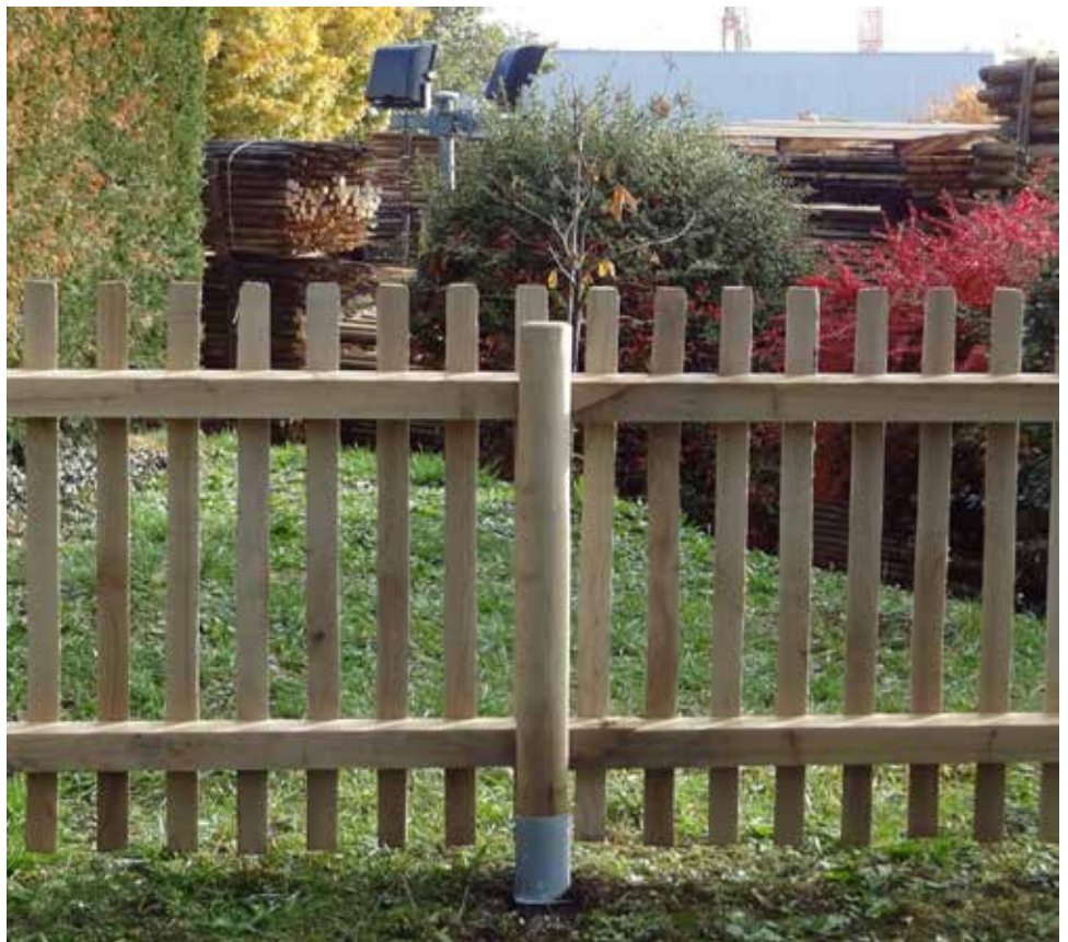
Latten aus Kastanienholz gefräst, Spitze gefast, Stärke ca. 24 mm, Breite 50 mm, Lattenabstand ca. 5 cm.
