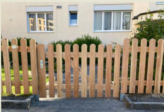
Holzkonstruktion Lärche Leimholz ohne Imprägnierung. Schlossbrett, Schloss mit Schlüssel. Verzinkte Bänder und verstellbare Kloben. Senkrechtzaunlattenbreite 9,3 cm, oben gerundet ohne Pfosten und Montage. Lichtbreite 80 - 120 cm.
