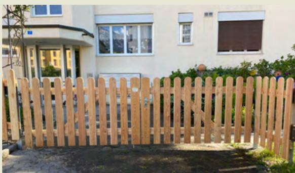
Holzkonstruktion Lärche Leimholz ohne Imprägnierung. Gleichflüglig mit 2 Schlossbrettern, Schloss mit Schlüssel inkl. Sperr-Riegel und Bodenhülse. Verzinkte Bänder und verstellbare Kloben. Senkrechtzaunlattenbreite 9,3 cm, oben gerundet. **Ohne Pfosten** und Montage.
