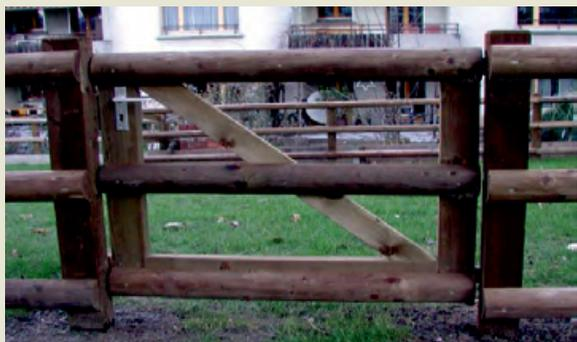
Holzkonstruktion ausgeblattet und verschraubt mit INOX. Schlossbrett, Schloss mit Schlüssel. Verzinkte Bänder und verstellbare Kloben. Verkleidung mit Querlatten, halbrund braun imprägniert ohne Pfosten und Montage. Lichtbreite 80 - 120 cm.
