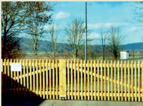
Holzkonstruktion Fichte kesseldruckimprägniert braun. Gleichflüglig mit 2 Schlossbrettern, Schloss mit Schlüssel Sperr-Riegel und Bodenhülse, verzinkten Bändern verstellbare Kloben, **Palisaden Breite 6 cm oben gekegelt**. Ohne Pfosten und Montage.
