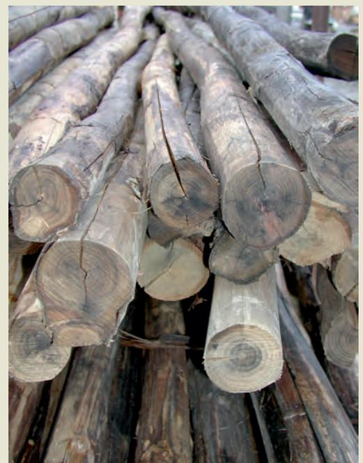
Das Rundholz ist von Natur aus resistent gegen Feuchtigkeit, Pilzbefall und Fäulnis.
