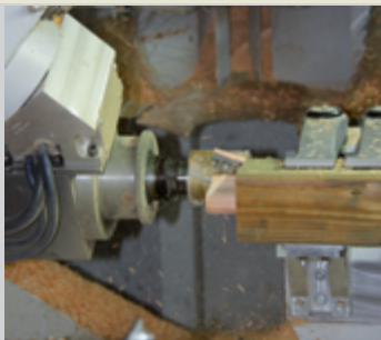
Passgenaue Verbindungen durch Bearbeitung der Hölzer mit moderner CNC-Technologie
