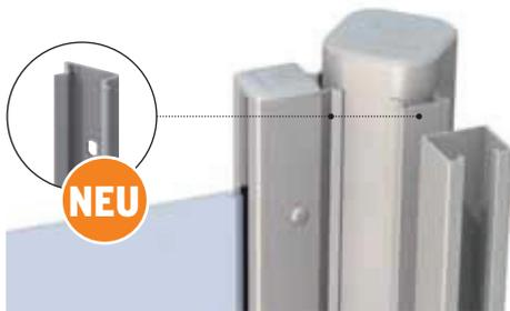
Dieser Adapter dient zur Aufnahme der U-Profile und der U-Klemmprofile am Metallpfosten. Er ermöglicht eine Zaunmontage mit z. B. Glasfeldern in einem Winkel von 45°-135°.
