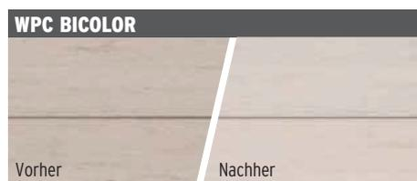
Hier werden dem Ursprungs-WPC in einem speziellen technischen Verfahren weitere Farbpigmente beige-mischt. Die so entstehende Struktur und Pigmentierung lässt das Material mit ihren Farbnuancen natürlich wirken. Jedes Profil ist dadurch in der Oberfläche, unterschiedlich. Abweichungen zwischen einzelnen Artikeln oder Fertigungschargen sind material- und produktionsbedingt unvermeidbar.
