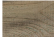
Umweltkeime, Stockflecken und leichter Schimmelbefall
