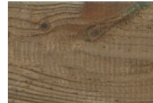
Rauhe Stellen auf der Holzoberfläche
