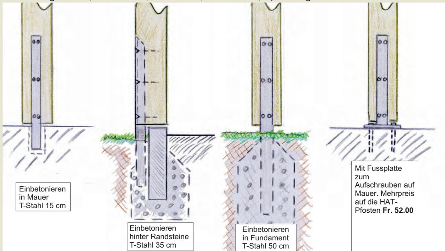
Mit Fussplatte zum Aufschrauben auf Mauer. Mehrpreis auf die HAT-Pfosten Fr. 52.00
