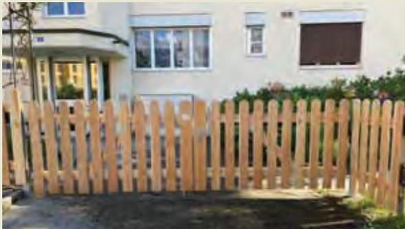
Holzkonstruktion Lärche Leimholz ohne Imprägnierung. Gleichflüglig mit 2 Schlossbrettern, Schloss mit Schlüssel inkl. Sperr-Riegel und Bodenhülse. Verzinkte Bänder und verstellbare Kloben. Senkrechtzaunlattenbreite 9,3 cm, oben gerundet. **Ohne Pfosten** und Montage. - Swiss Made
