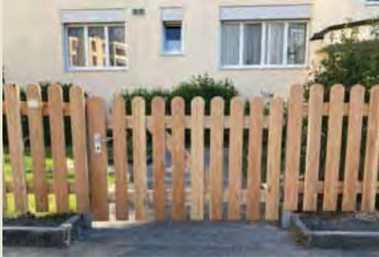
Holzkonstruktion Lärche Leimholz ohne Imprägnierung. Schlossbrett, Schloss mit Schlüssel. Verzinkte Bänder und verstellbare Kloben. Staketten Breite und Kopfform nach Wahl, ohne Pfosten und Montage. Lichtbreite 80 - 120 cm.
