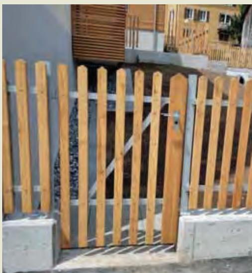
Stahlrahmen feuerverzinkt. Schlossbrett, Schloss mit Schlüssel und verstellbaren Kloben. Senkrechtzaunlattenbreite 9,3 cm, oben gerundet ohne Pfosten und Montage. Lichtbreite 80 - 120 cm. • Swiss Made
