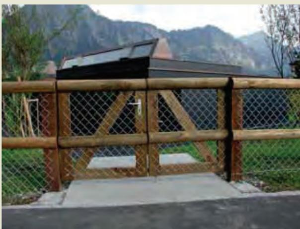
Holzkonstruktion **ausgeblattet** und verschraubt mit INOX. Schlossbrett mit Schloss und Schlüssel. Feuerverzinkte Bänder und verstellbare Kloben. Verkleidung mit Halbrundlatten. Festeler mit Bodenhülse. **ohne Pfosten**, ohne Montage. - Swiss Made
