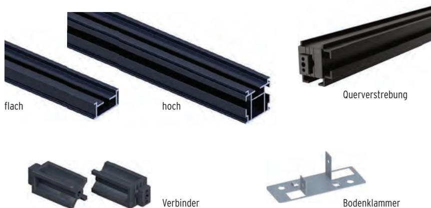
Die **Unterkonstruktion aus Aluminium** (ALU UK) ist extrem haltbar und verwindungsstabil. Die UK „hoch“ (40 x 40 mm) kann mit Hilfe der Verbinder (2068) zu einem verzugsarmen Rahmen montiert werden. Fixieren Sie die UK mit den Bodenklammern am Untergrund. Durch den Einsatz von **Querverstreibungen** stellen Sie eine verbindungssteife Unterkonstruktion sicher. Bitte nutzen Sie die DREAMDECK ALU Aufbauanleitung für weitere Informationen.
